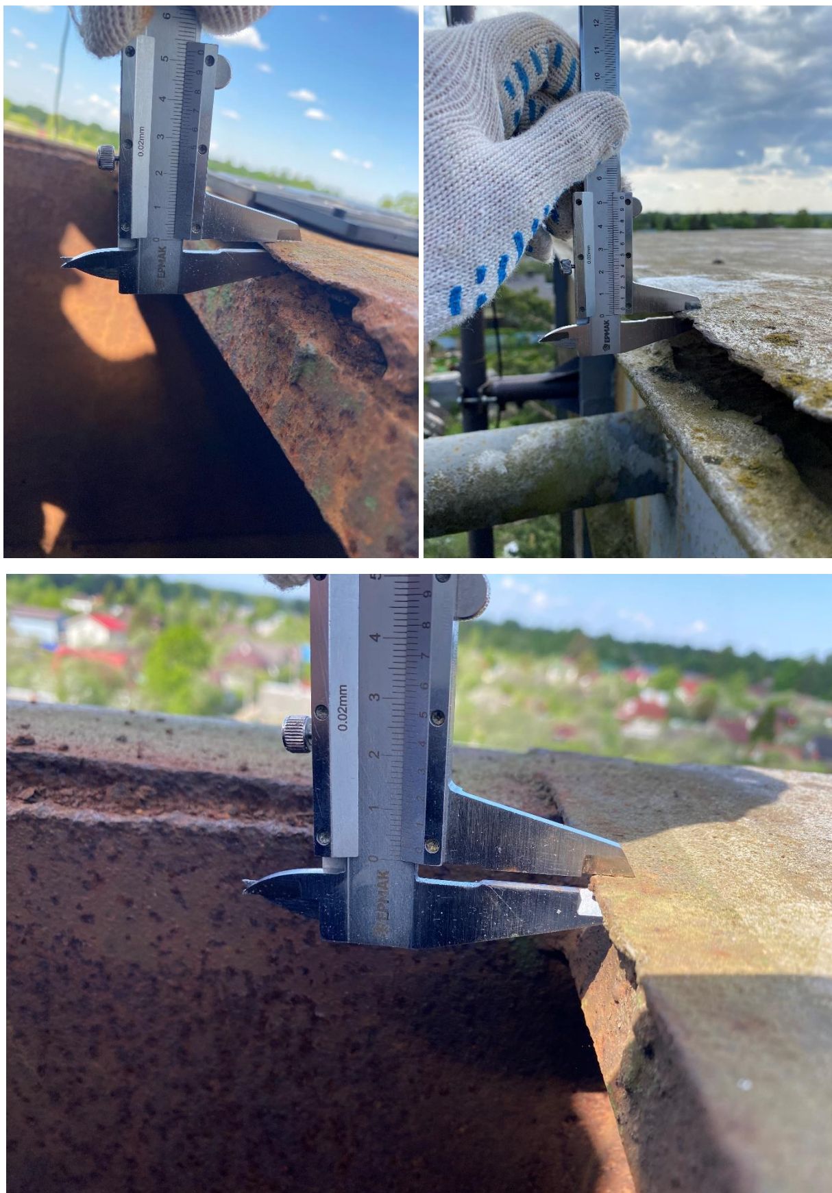
Фото №12-14. Замер толщины крышек емкостей.
