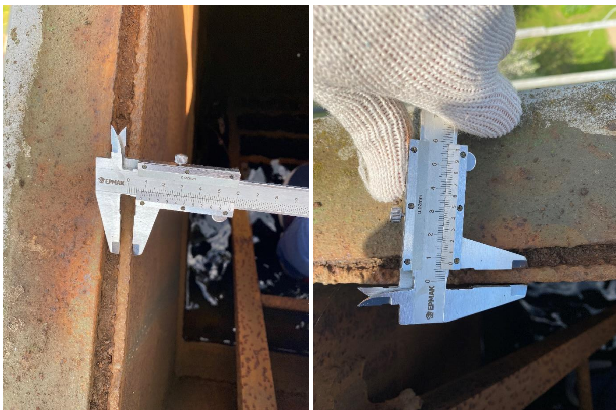
Фото №7,8. Замер толщины стенок емкостей.
