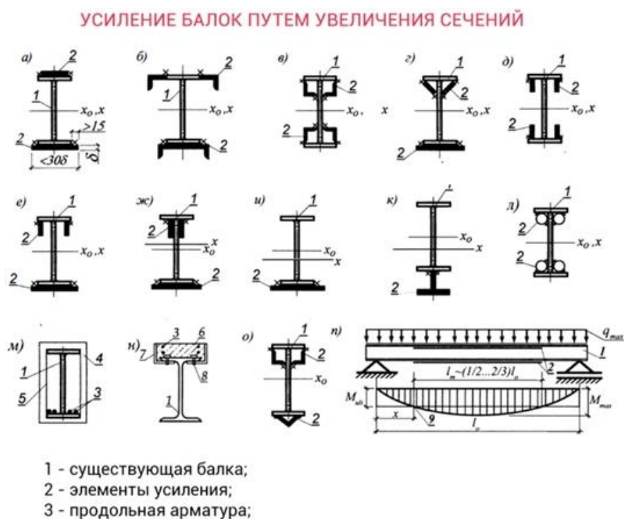
Рис. №1. Схема усиления балок.
